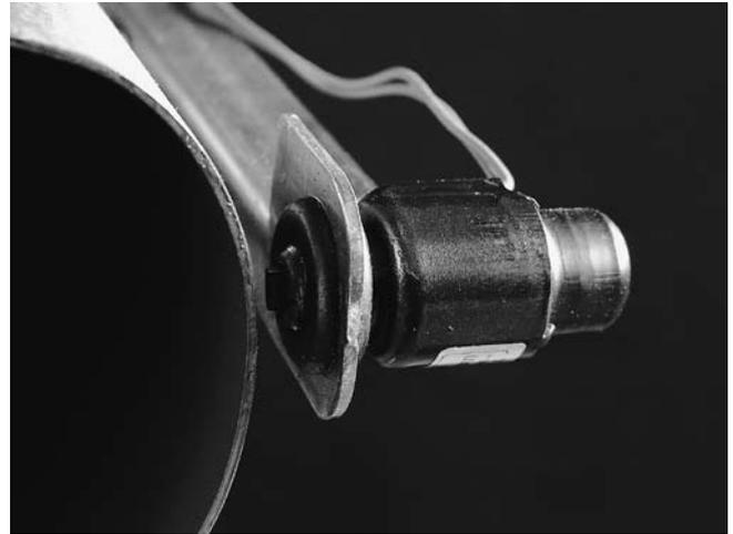
Bild 5: Typewriter-Magnet. (Foto: C. Schläger)
